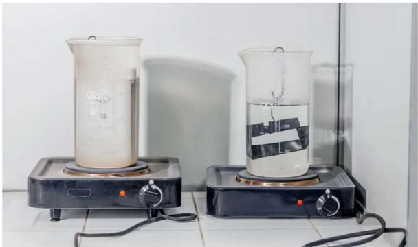
Тест Маха (Machu): проверка адгезии после кипячения.
